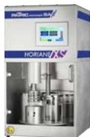
Produites par **Patric Concept SA** à Colombier/NE, les machines de la gamme Horiane répondent aux normes de sécurité en vigueur pour l'utilisation des solvants tels que les alcools, les benzines, l'acétone ou autre produit d'épilage. Certification ATEX selon EXII 1/2/3 IIB T4.
