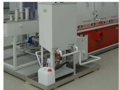
Ölabscheider UNI – separiert aufschwimmende Öle und Fette
