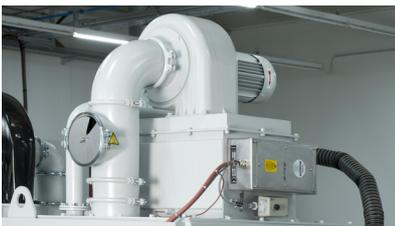
Lufterhitzer mit Blasdüsen – trocknet das Werkstück
