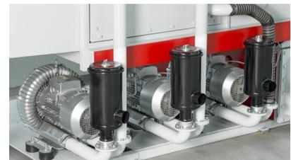
Seitenkanalverdichter (Option) – optimierte Trocknungsergebnisse
