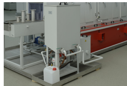
Séparateur d'huile UNI - pour les huiles et graisses en surface
