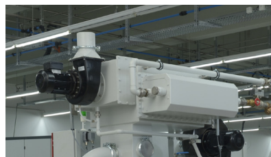
Condenseur refroidi à eau (option) - aspiration et condensation de vapeur
