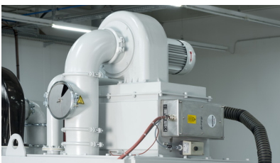
Réchauffeur d'air avec buses de soufflage pour sécher les pièces
