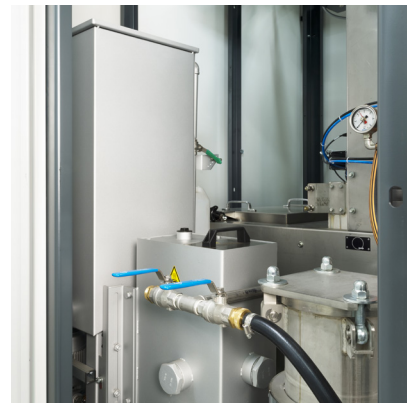
Uni-Entöler & Feinfilter im Gehäuse integriert
