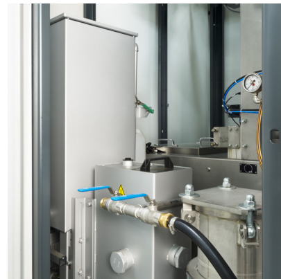
Déshuileur UNI & filtration fine intégrés dans le carter de la machine
