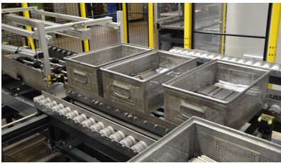
Warenträger-Einlauf aus der Fertigung, einspurig
