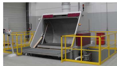
Machine avec tiroir intégré (en option) – encastrée au sol
