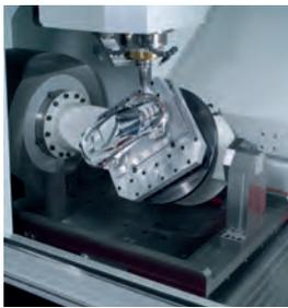
Selbst die härtesten Materialien, wie gehärteter Stahl, Titan und Hartmetalle können genau und zuverlässig gefräst werden. Kupfer, Edelmetalle, Aluminium und Grafit werden ebenfalls problemlos bearbeitet.
